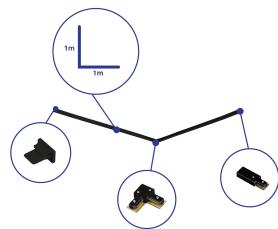
Technische Daten Rail Set 1-Phasen L 1 x 1 Meter Schwarz | incl. Abschlusskappe, Stromanschluss und L -Verbinder
