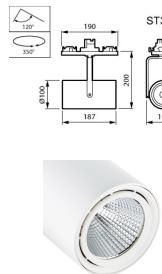
Technische Daten Philips LED Schienenstrahler Spot Greenspace Maxos Fusion GEN2 ST321S Weiß 19W 2700lm 38D - 830 Warmweiß
