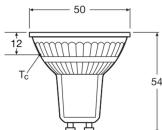
Technische Daten Ledvance Superior LED Spot Reflektor GU10 PAR16 2W 360lm 36D - 827 Extra Warmweiß | Ersatz für 50W
