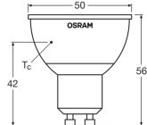
**Technische Daten Osram Parathom Retrofit Led-Spot GU10 PAR16 5W
